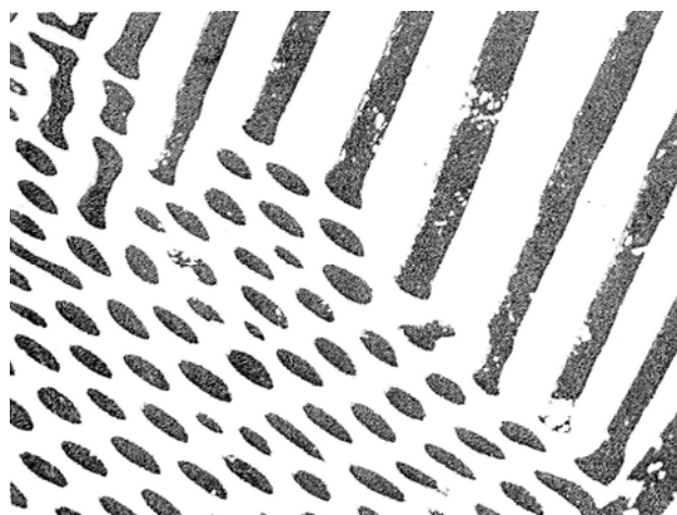
شکل ۹: ناحیه یوتکتیکی از شکل ۸ با بزرگنمایی بیشتر. طبیعت میله‌ای شکل آستنیت در لدبوریت کاملاً دیده می‌شود. آستنیت مزبور در درجه حرارت استحاله یوتکتوئیدی به پرلیت تبدیل شده است. بزرگنمایی ۵۰۰
