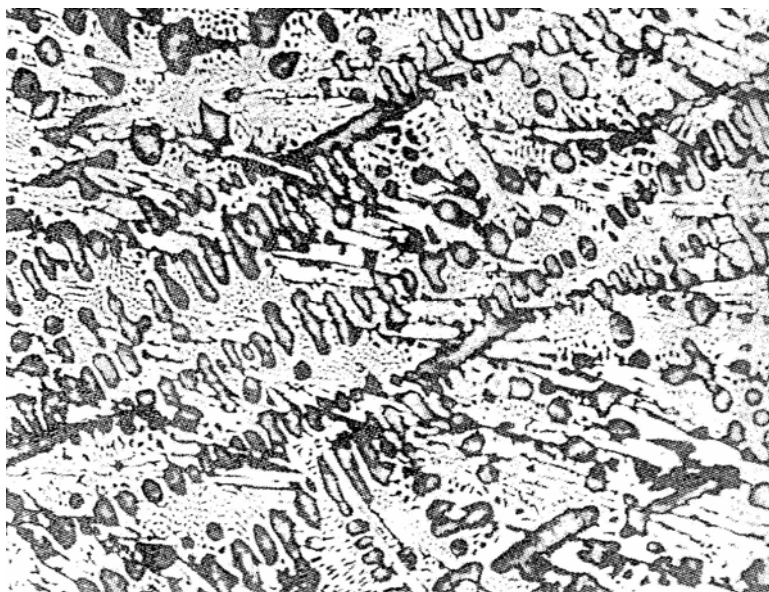
شکل ۴: تصویر میکروسکوپی چدن سفید هیپوئکتیک، نواحی پرلیت دندریتی شکل (آستنیت اولیه) و یوکتیک لدوریته کاملاً مشخص است. محلول اچ پیکرال . بزرگنمایی ۱۰۰
